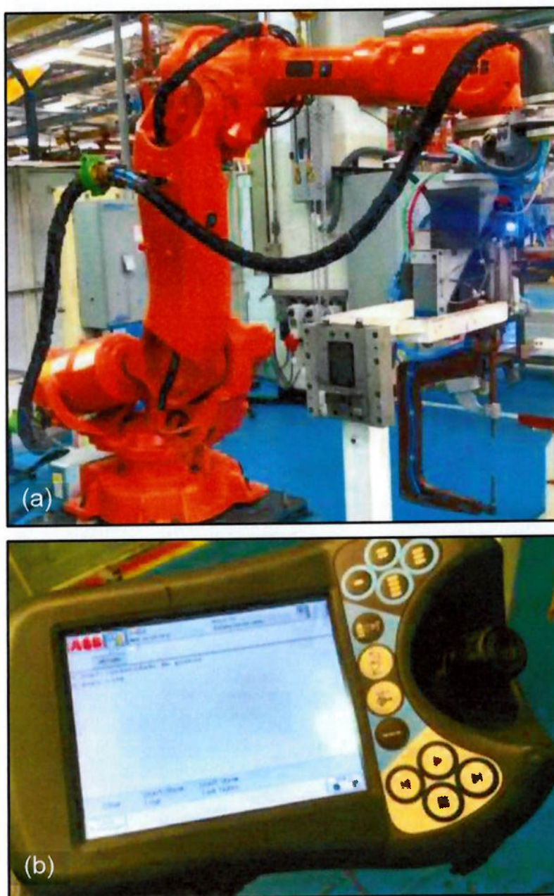
Figura 4.9 - Detalhe do robô manipulador ABB (a) e interface de programação e controle do robô flex pendente (b), utilizados para realização dos ensaios de soldagem.
