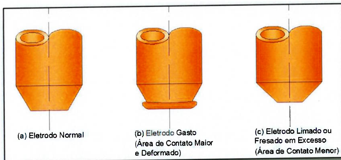
Figura 3.40 - Efeito do desgaste do eletrodo na superfície de contato. Adaptado de (WEINER, et al., 1992).
