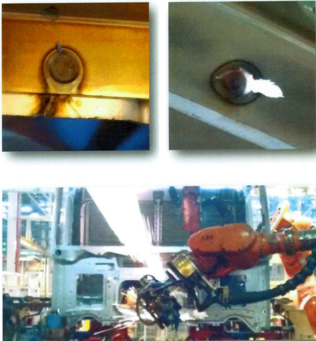
Figura 3.51 - Exemplos de soldagens com expulsão de material (autoria própria).
