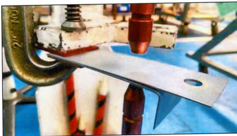
Figura 4.5 - Chapas utilizadas para a definição do diagrama de soldabilidade fixadas em suporte adaptado e isolado.
