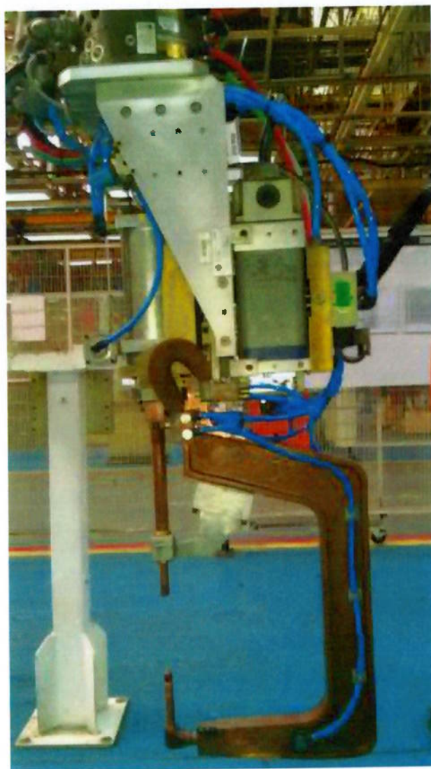
Figura 4.8 - Pinça pneumática de corrente alternada de soldagem por pontos utilizada nos testes.
