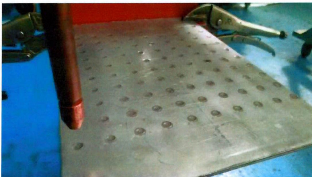
Figura 4.17 - Chapa utilizada no teste de rendimento dos eletrodos.
