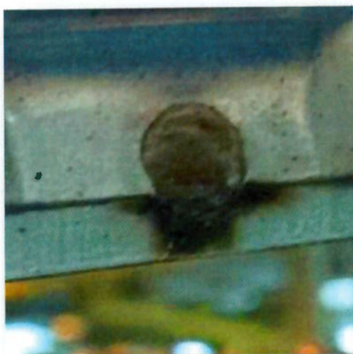
Figura 3.47 - Soldagem de borda (autoria própria).
