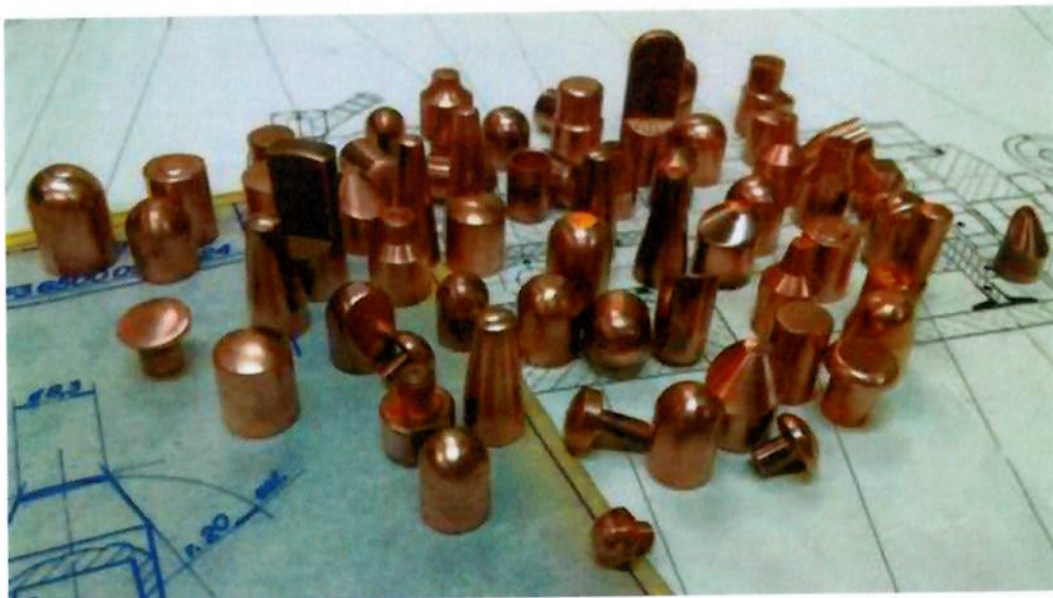
Figura 3.33 - Diversos tipos de eletrodos utilizados na indústria (autoria própria).
