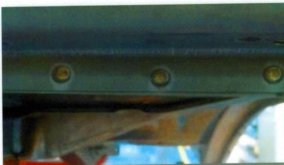
Figura 3.43 - Formação de latão na superfície da chapa durante a soldagem de cabinas de caminhões (autoria própria).
