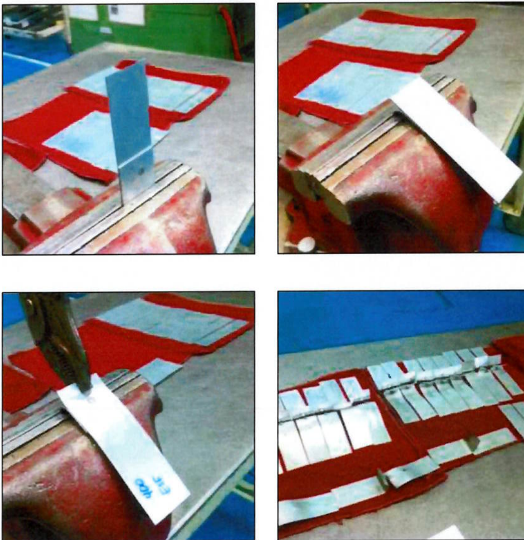
Figura 4.28 - Sequencia do ensaio por arrancamento.
