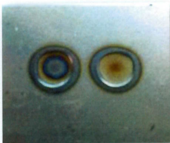
Figura 3.48 - Soldagem próxima demais (autoria própria).
