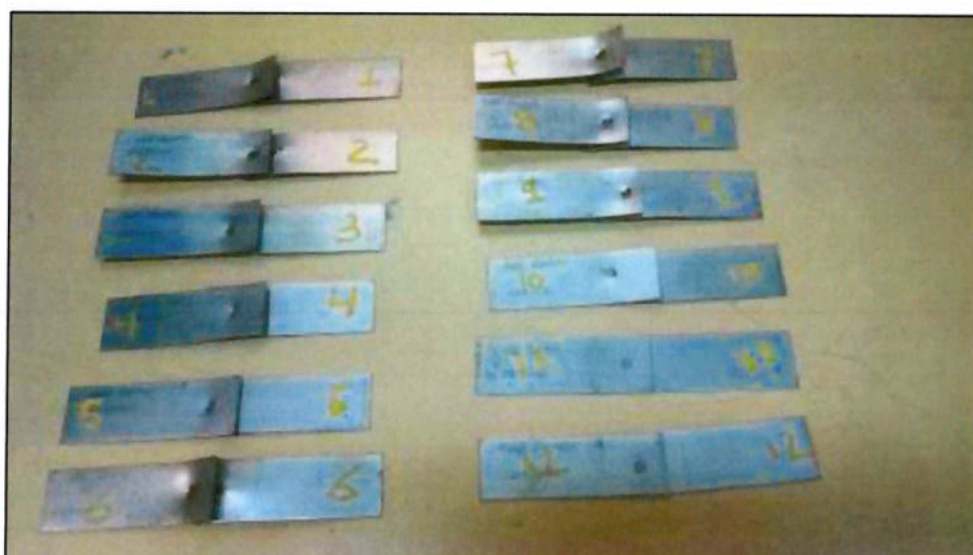
Figura 4.27 - Corpos de prova submetidos ao ensaio de tração.
