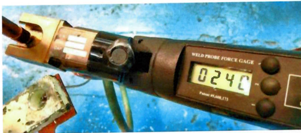
Figura 4.10 - Dinamômetro digital para verificação e calibração de força utilizada nos testes.
